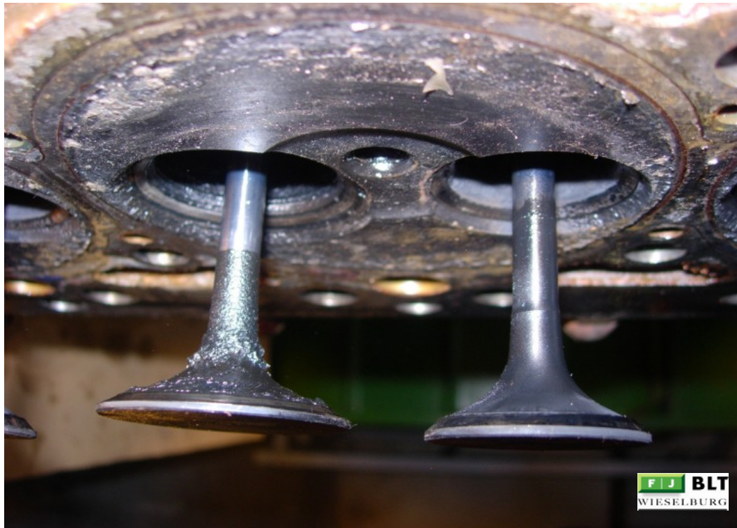
Abbildung 13: 14-NÖ Einlass- und Auslassventil
