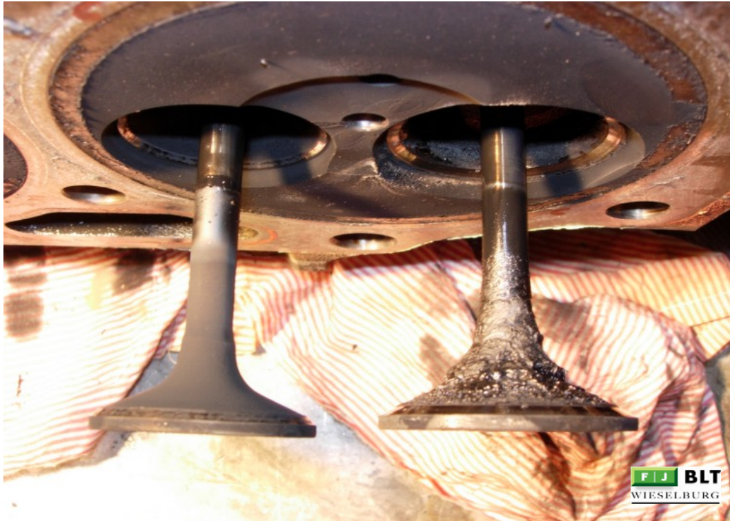
Abbildung 195: 25-NÖ Auslass- und Einlassventil
