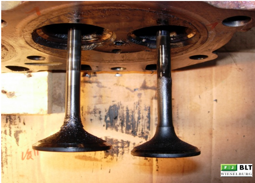
Abbildung 138: 21-NÖ Einlass- und Auslassventil
