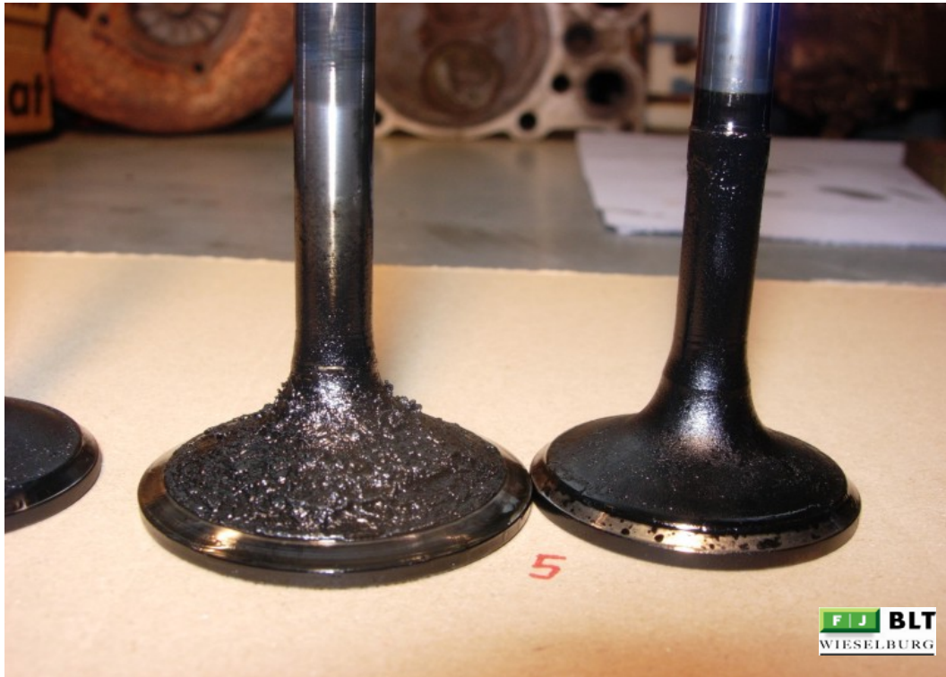
Abbildung 210: 26-NÖ Einlass- und Auslassventile
