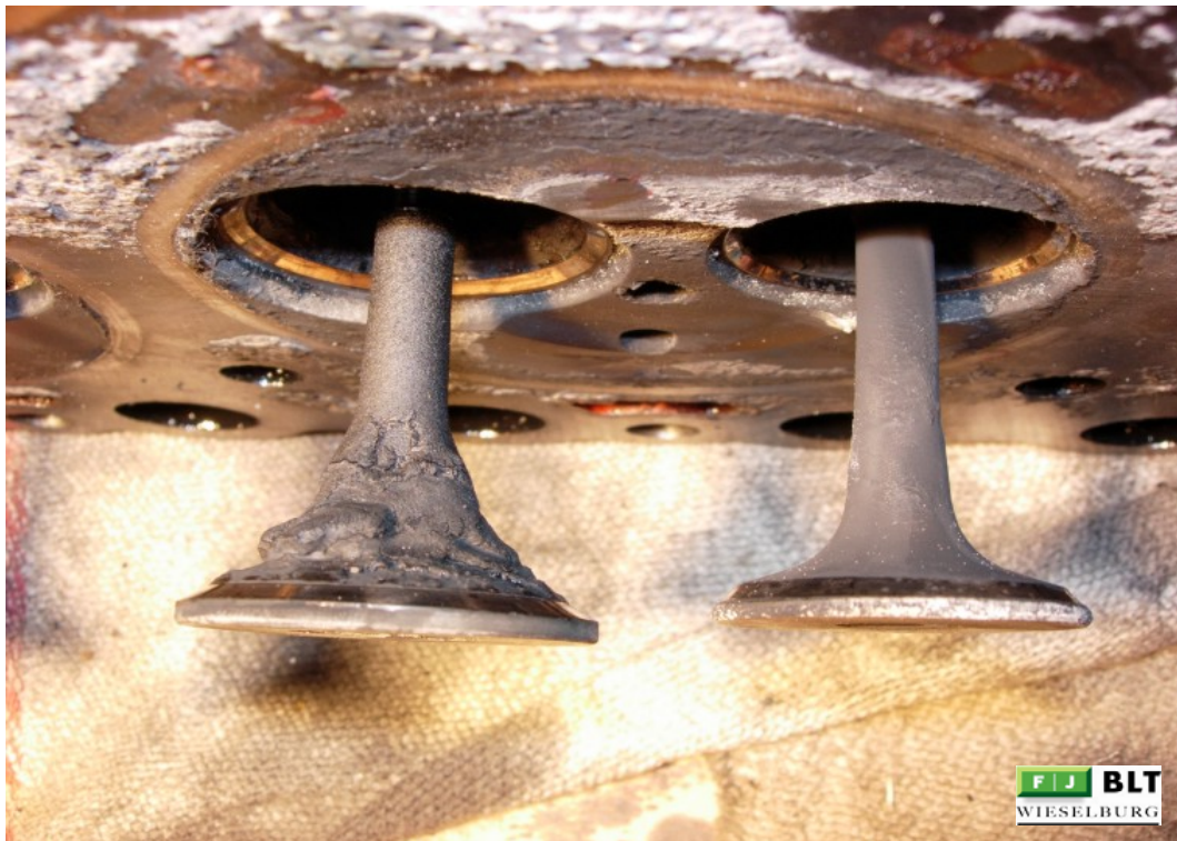
Abbildung 117: 20-NÖ Einlass- und Auslassventile
