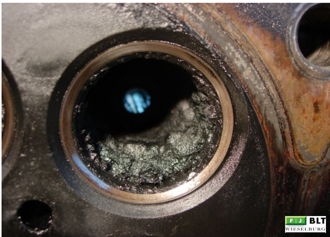
Abbildung 152: 10-OÖ Einlasskanal Zylinder 3
