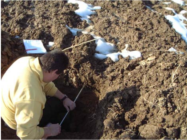
Abb. 3-2: Um den Einbau der Saugkerzen zu ermöglichen wurde in der jeweiligen Bodenschicht horizontal zur Grubenwand mit einem Edelstahlbohrer vorgebohrt. Dieser Bohrer weist den gleichen Durchmesser der Saugkerzen auf, um einen direkten Kontakt zwischen Boden und Kerze zu gewährleisten und die Gewinnung von Bodenlösung zu sichern
