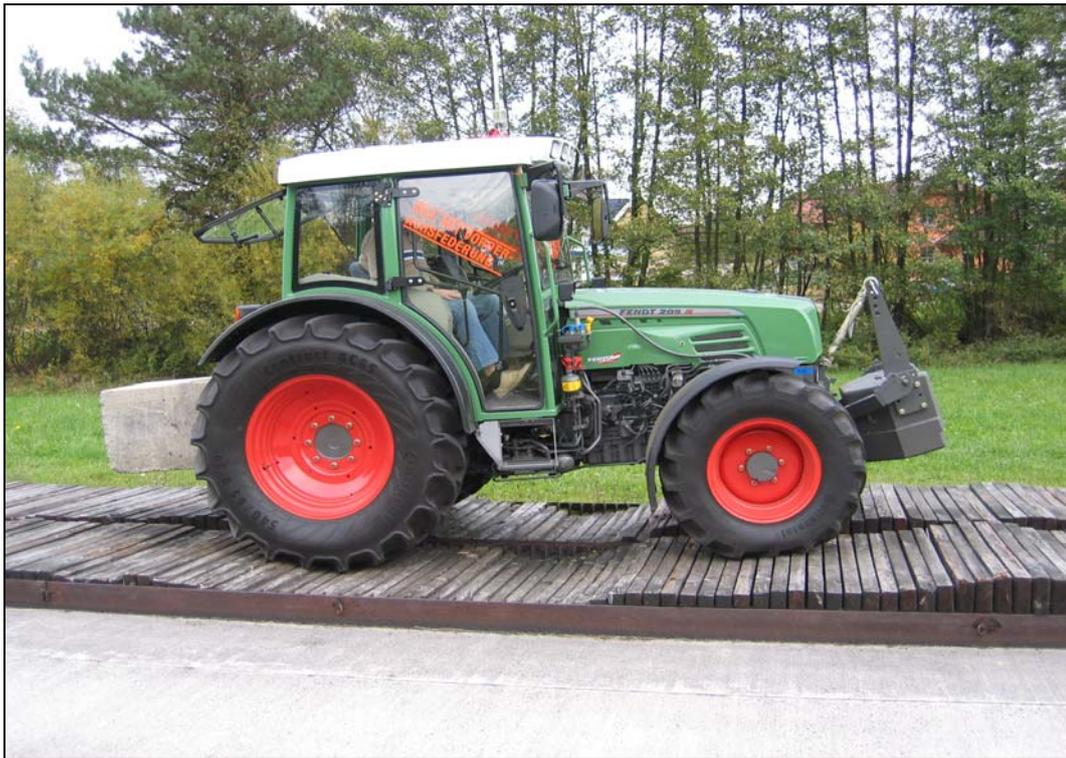
Abb. 32: Fendt „209S“ mit Vorderachsfederung
