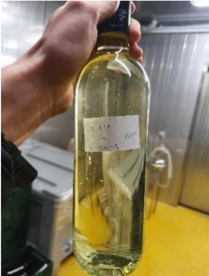
Abbildung 4: Zusatz von 200 mg/L Ca, starker Absatz am Boden
