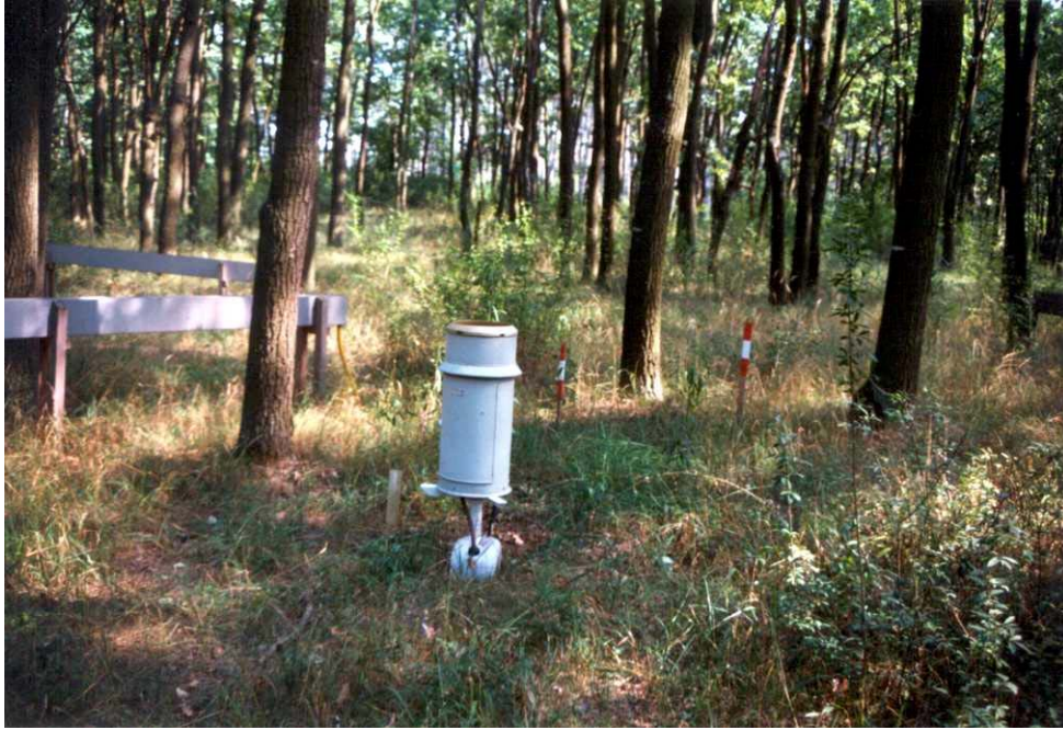
Abb. 7: Messpunkt „Eichenbestand“ mit Niederschlagsrinnen des Institutes für Waldbau
