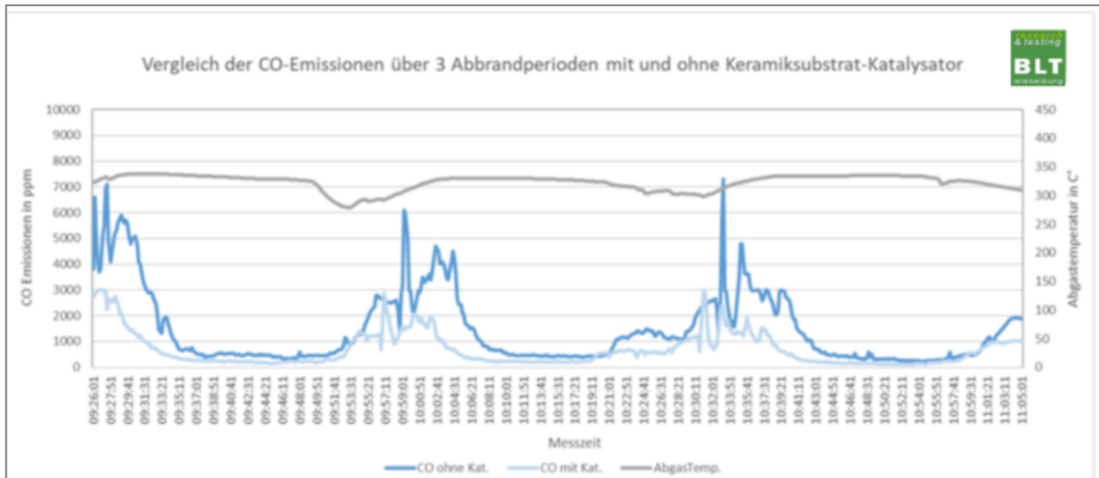
Abbildung 10: Verlauf der CO-Emissionen mit und ohne Keramikkatalysator sowie die Abgastemperatur eines Verbrennungsversuches über 3 Abbrandperioden.
