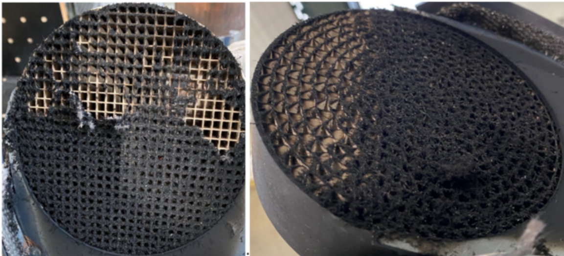
Abbildung 17: Staubablagerungen an den Katalysatoren und mit flächig begrenzten Abtragungen bei schräger Einbauvariante.
