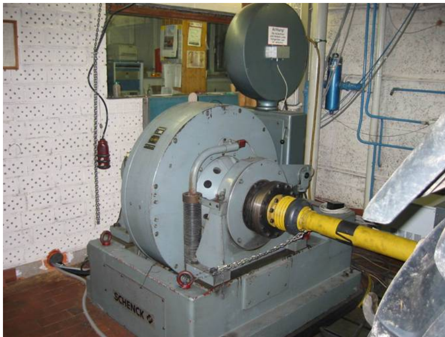
Abbildung 48: Schenk Wirbelstrombremse Type W 780
