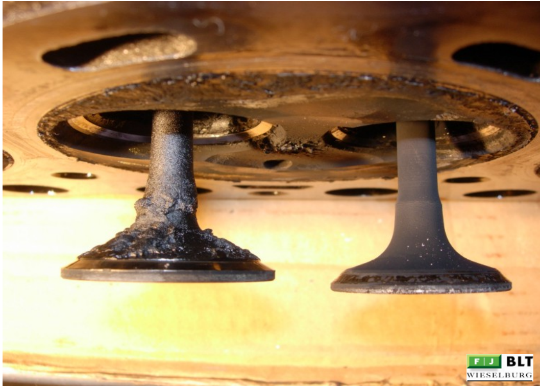
Abbildung 34: 29-NÖ Einlass- und Auslassventile
