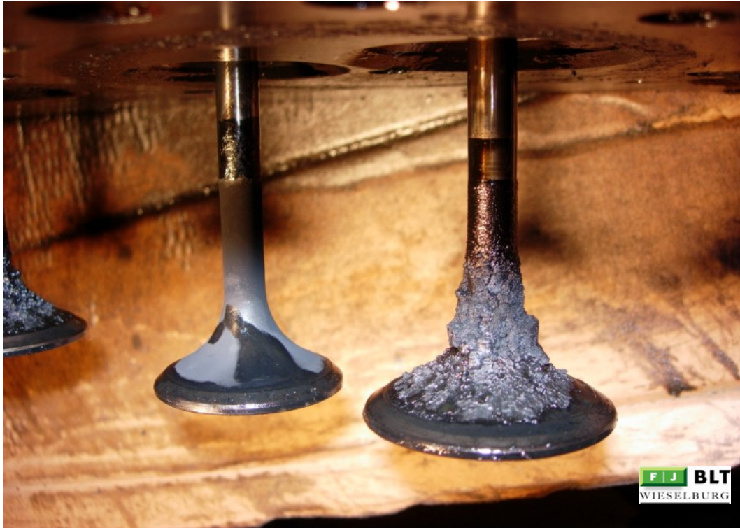
Abbildung 49: 30-NÖ Auslass- und Einlassventil
