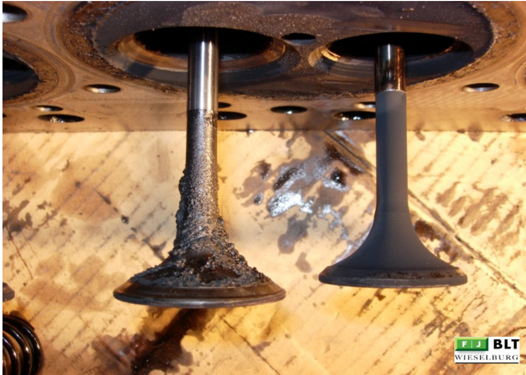
Abbildung 70: 31-NÖ Einlass- und Auslassventile
