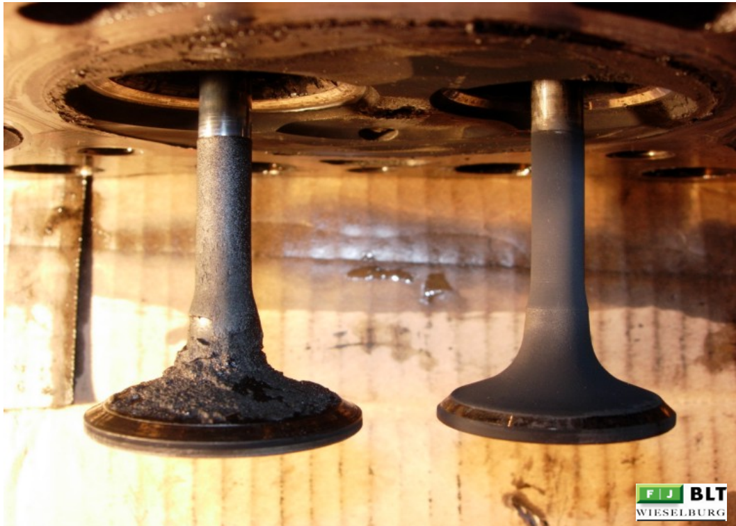
Abbildung 23: 28-NÖ Einlass- und Auslassventile
