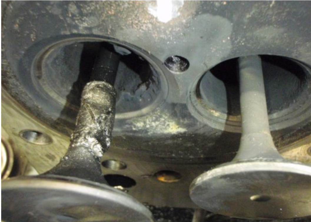
Abbildung 161: 37-NÖ Einlass- und Auslassventil
