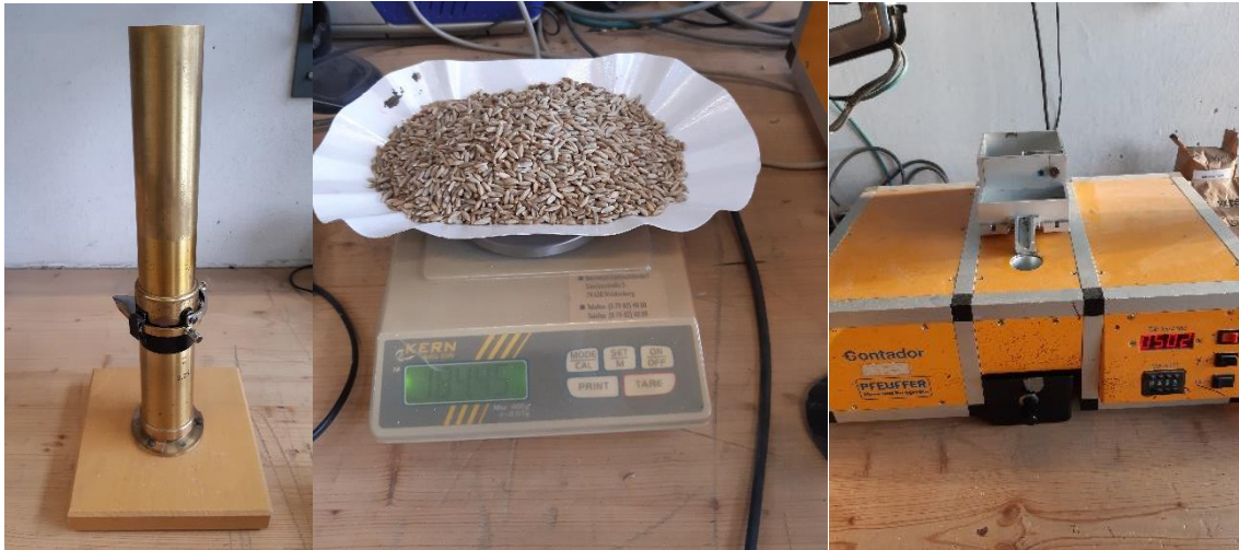
Abbildung 15: Messung der Hektolitergewichtes und der Tausenkornmasse: (i) Messzylinder Hektolitergewicht, (ii) Messung \frac{1}{4} L Gewicht, (iii) Körnerzählgerät Contador (v.l.n.r.)
