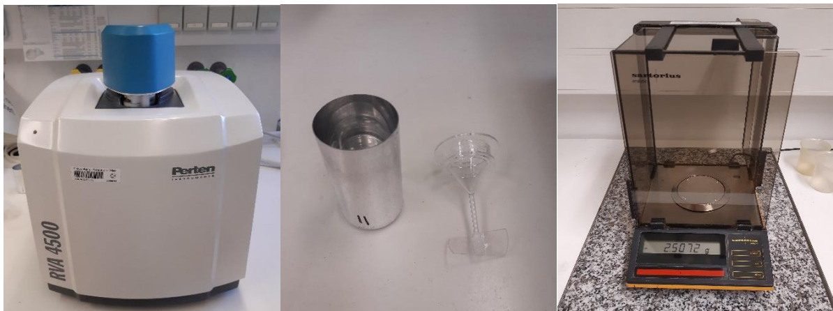
Abbildung 17: Bestimmung der Viskosität mittels Rapid Visco Analyser: (i) Perten RVA 4500 Rotationsviskosimeter, (ii) Aluminiumbehälter und Plastikpaddel, (iii) Laborwaage Sartorius A200S (v.l.n.r.)
