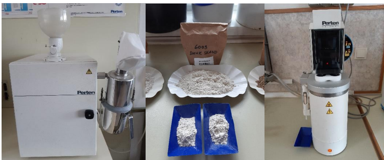
Abbildung 16: Messung der Fallzahl: (i) Labormühle Typ 3100, (ii) vermahlene Roggenprobe, (iii) Gerät zur Bestimmung der Fallzahl nach Hagberg (v.l.n.r.)
