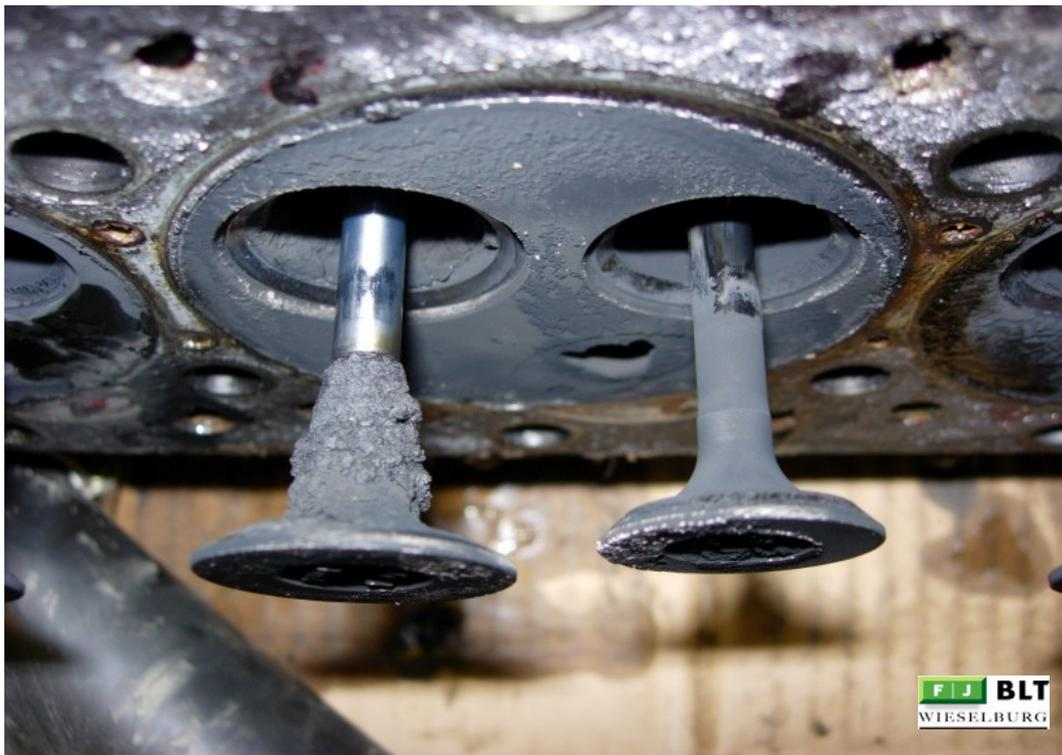
**Abbildung 180: 24-Bgld Einlass- und Auslassventile**
