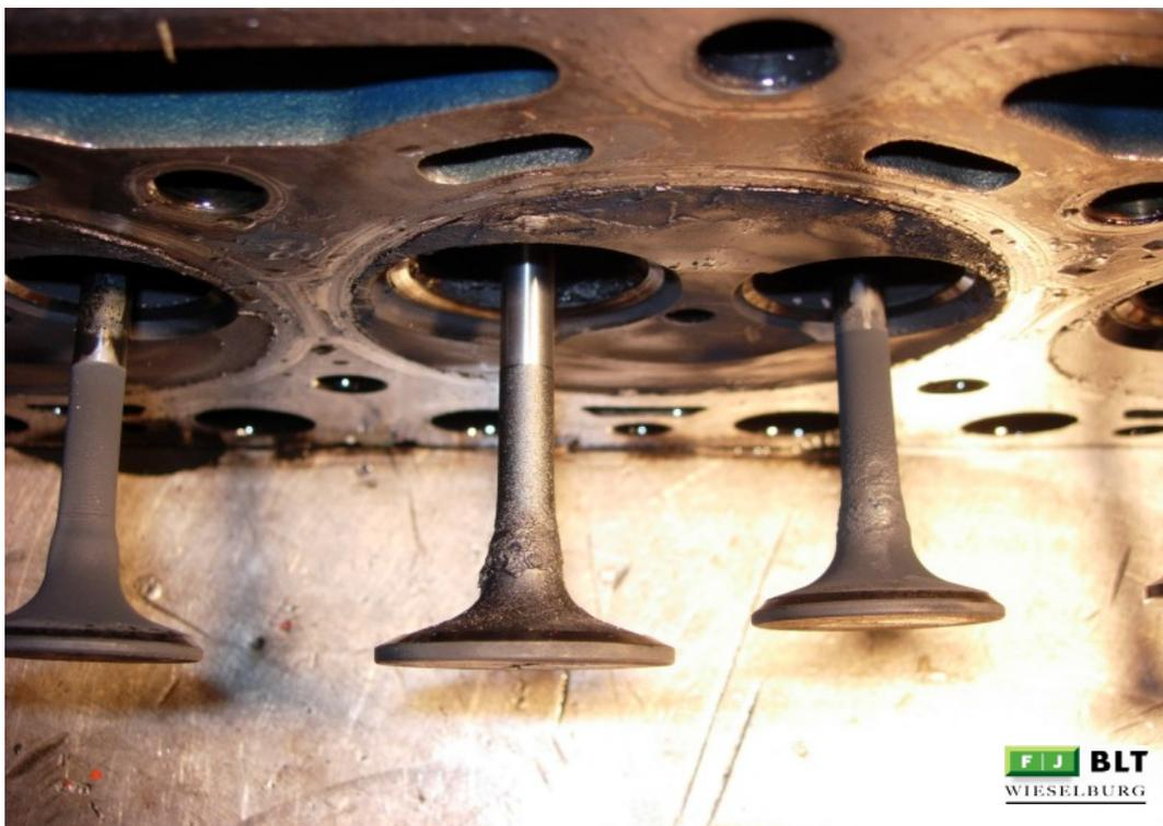
Abbildung 28: 15-OÖ Einlass- und Auslassventil
