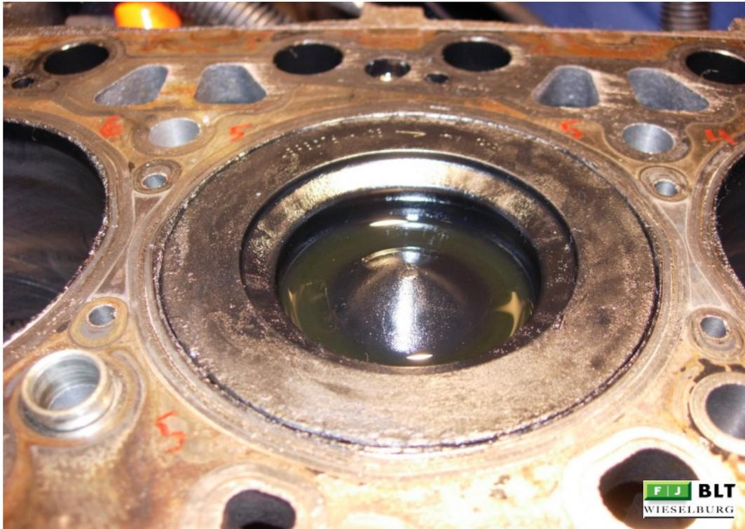
Abbildung 106: 19-OÖ Kolbenboden
