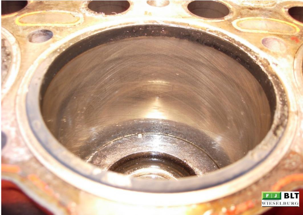
Abbildung 196: 25-NÖ Zylinderlaufbüchse
