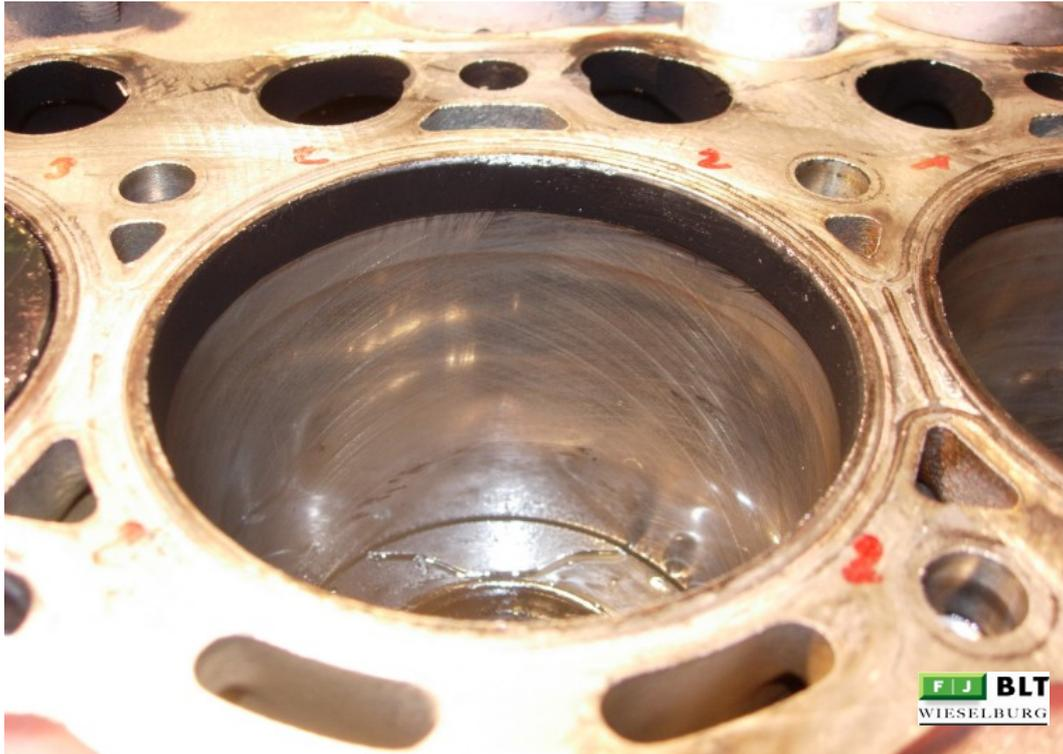
**Abbildung 155: 22-NÖ Zylinderlaufbüchse**
