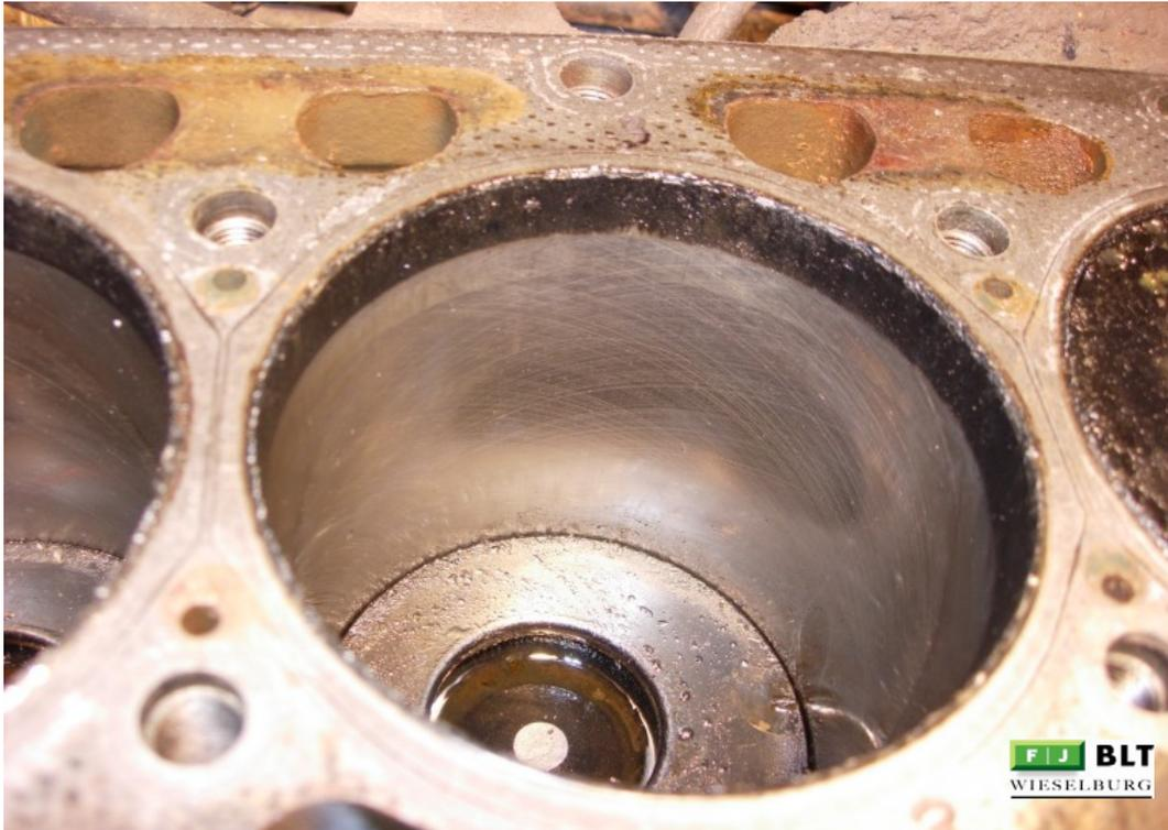
Abbildung 14: 14-NÖ Zylinderlaufbüchse
