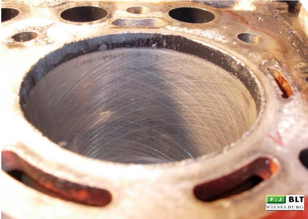
Abbildung 118: 20-NÖ Zylinderlaufbüchse
