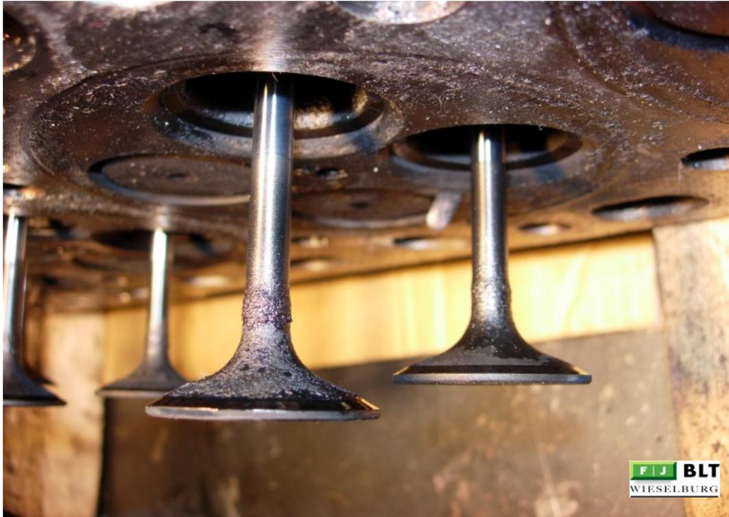
Abbildung 89: 18-OÖ Einlass- und Auslassventile
